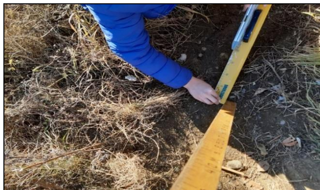
Рис.23. Привязка гидрологического поста к системе высот
