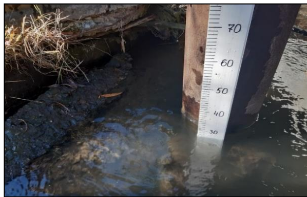
Рис.23. Привязка гидрологического поста к системе высот
